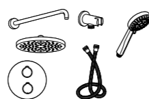
T-500 5D0618C00 Комплект встраиваемый с термостатическим смесителем.
