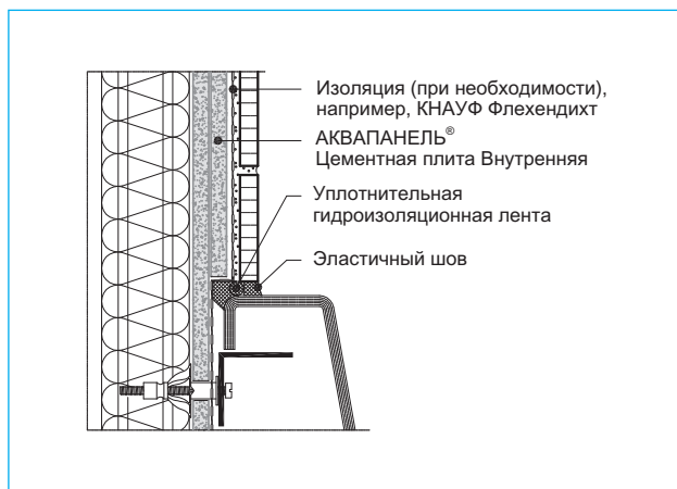
Крепление ванны (двухслойная облицовка)
