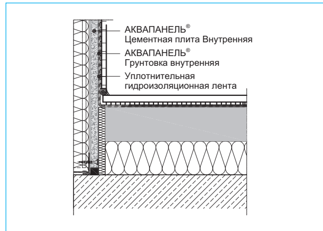
Гидроизоляция облицовки и пола
