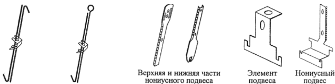
Рисунок 13 - Варианты подвесов системы Trulok
