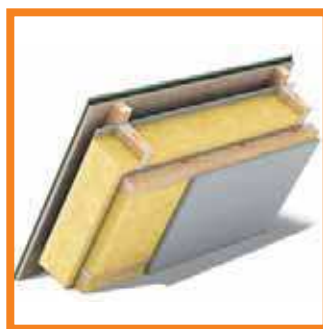
Схема утепления двумя слоями теплоизоляции
