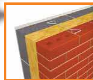
Конструкция слоистой кладки с воздушным зазором между слоем теплоизоляции и облицовочным материалом
