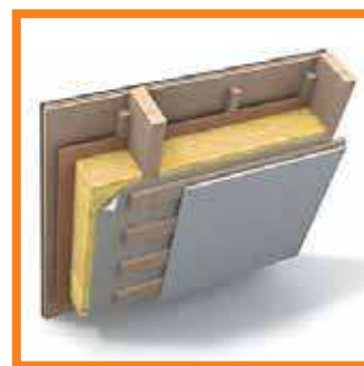
Схема утепления одним слоем теплоизоляции
