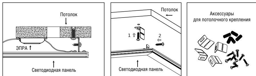
– Рисунок 5. Монтаж при помощи комплекта LP-КПП-Д –
