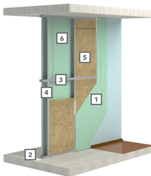
Рисунок 20. Перегородка с плитами АКУСТИК БАТТС
